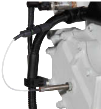
Pick-up an Motor installiert
